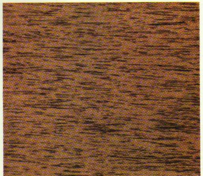
Electroplating-Kupfergefüge in 75facher Vergrößerung.
